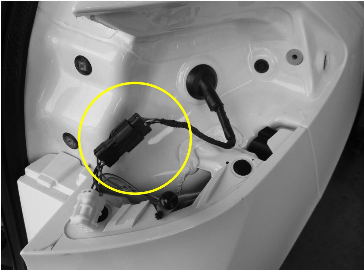
Den fahrzeugseitigen Heckleuchtenstecker in den passenden Gegenstecker des Kabelsatzes einstecken und verrasten.
