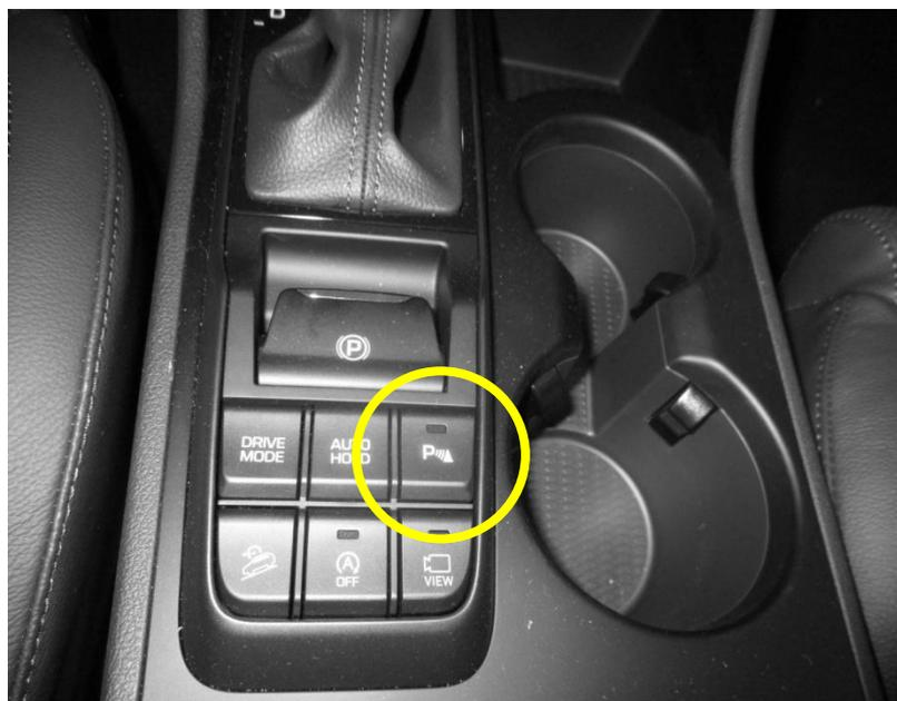
Die werksseitig eingebaute Einparkhilfe kann bei Bedarf mit dem Schalter in der Mittelkonsole deaktiviert werden.
