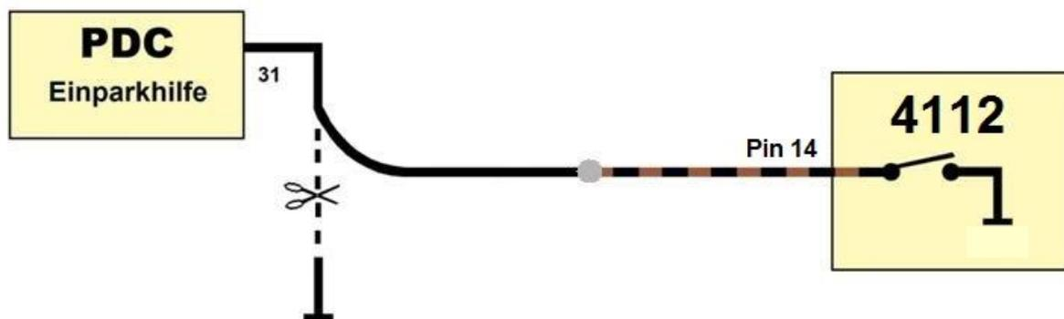
Ein PDC-Modul mit Metallgehäuse muss gegebenenfalls isoliert montiert werden!
