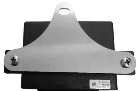
Das Anhängersteuermodul 4112 auf den 24-pol. Sockel aufstecken und im markierten Bereich an der oberen Schweißmutter mit der M6 x 20 Schraube und Federring befestigen.
