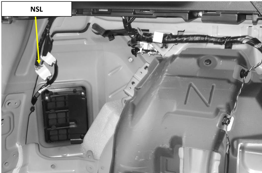
Die rosafarbene NSL-Leitung des 22-pol. Steckers **ausmessen (!)** und an geeigneter Stelle durchtrennen. Beide Leitungsenden 5 mm abisolieren.
