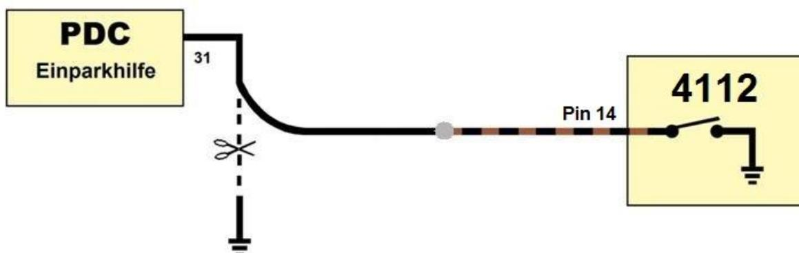
Gegebenenfalls muss bei einem PDC-Modul mit Metallgehäuse, dieses isoliert montiert werden!
